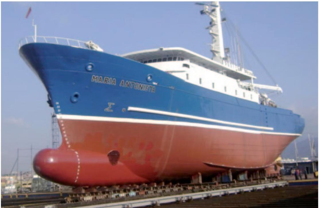
Figura 14.6 - Adattamento di uno scafo esistente con l'introduzione di un bulbo prodiero.
